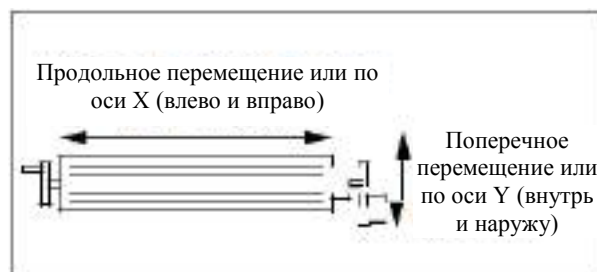
Рисунок 16. Направления хода стола.
