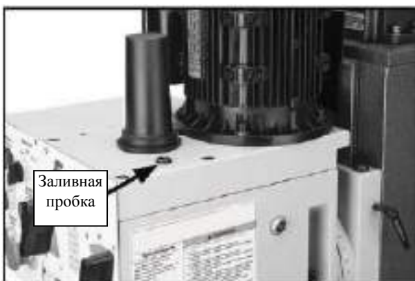
Рисунок 26. Маслозаливная пробка шпиндельной бабки.
