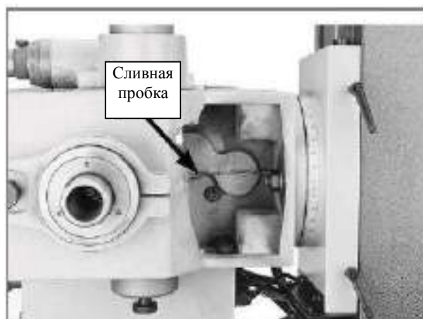
Рисунок 27. Сливная пробка шпиндельной бабки (для ясности шпиндельная бабка наклонена под углом 90°).
